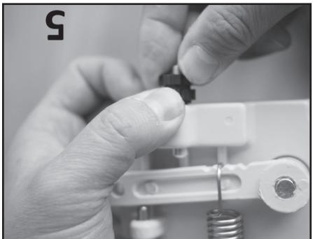
2. Desenrosque la tuerca inferior mientras sujetela la superior para evitar que se junte en el eje.
