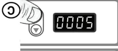
c. A continuación, apriete ▲ y LED muestra 100-5000, que significa la velocidad máxima del motor en RPM.
