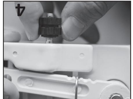
1. Note el pedaleo espacio entre el eje de inicio lento y la barra del pedal.
