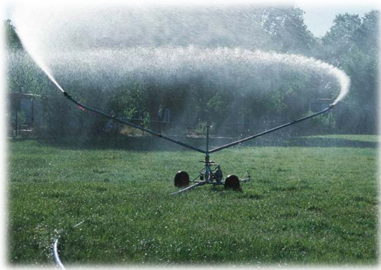
Mini gun sprinkler system
