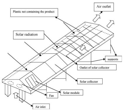
Fig. 7. Solar tunnel drier.
