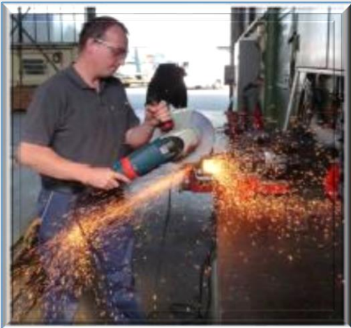
CORTE Y PREPARACIÓN MANUAL DE LA JUNTA A BASE DE RADIAL (LENTO Y PELIGROSO)
