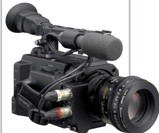
Professionelle Mikrofone werden über einen (Mono) oder zwei XLR-Stecker (Stereo) angeschlossen und, sofern phantomgespeiste Kondensatormikros, darüber mit Strom versorgt.
