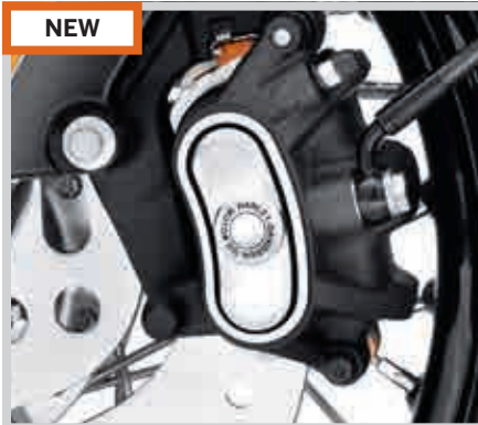
D. BRAKE CALIPER INSERTS
