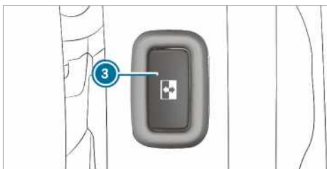
Schuifdeurtoets op het deurframe (B-stijl)
