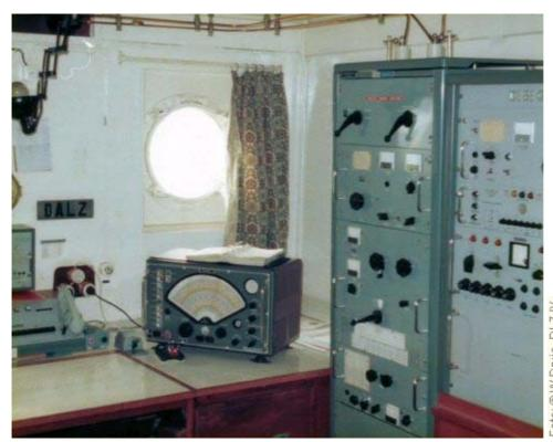
Sendergestell befindet sich als Hauptsender der Station ein ST1400 von Standard Radio&Telefon für Telegrafie auf Mittel-, Grenz- und Kurzwelle sowie für SSB-Telefonie und Funkfernschreiben im oberen Seitenband auf Grenz- und Kurzwelle. In der Endstufe arbeiten 4 Röhren 4CX250B in einem kühlenden Luftstrom (Zwangskühlung) und verleihen dem Sender Leistungen von 400W (MW A1), 200W (MW A2), 1200W (GW/KW A1) ui A3J). Der S 3x220 A1) und 1500W (KW
