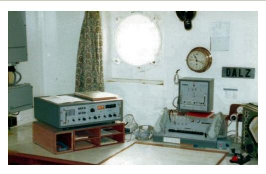
Rechts im im Bild erkennt man gerade noch den <u>Allwellenempfänger Siemens E 566</u>. Er erfasst in 12 Teilbereichen die Frequenzen 14 - 21 kHz und 85 - 30300 kHz in den Betriebsarten A1, A2 und A3. Links neben dem RX steht eine <u>Morsetaste der Firma Junker</u> auf dem Tisch.
