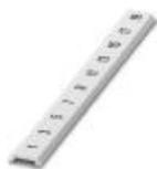
Плоские планки Zack, Полоса, белый, с маркировкой, надписи вдоль: нечетные номера 1-19, 21-39 и т.д. до 81-99, тип монтажа: крепление в плоских пазах для табличек, для клемм шириной: 6,2 мм, размер маркировочного поля: 5,15 x 6,15 мм, Количество отдельных табличек: 10
