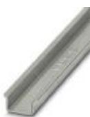
Несущая рейка без перфорации, Стандартный профиль 2,3 мм, ширина: 35 мм, высота: 15 мм, согласно EN 60715, материал: Сталь, оцинкован., пассивирован., длина: 2000 мм, цвет: серебристый
