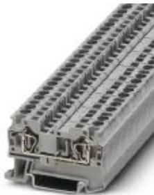
Проходные клеммы, номинальное напряжение: 800 В, номинальный ток: 32 А, тип подключения: Пружинный зажим, количество точек подсоединения: 2, сечение: 0,08 мм<sup>2</sup> - 6 мм<sup>2</sup>, AWG: 28 - 10, ширина: 6,2 мм, цвет: серый, тип монтажа: NS 35/7,5, NS 35/15
