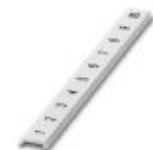
Плоские планки Zack, Полоса, белый, с маркировкой, надписи вдоль: нумерация по порядку 1 ...10, 11 ...20 и т.д. до 91 ...100, тип монтажа: крепление в плоских пазах для табличек, для клемм шириной: 6,2 мм, размер маркировочного поля: 5,15 x 6,15 мм, Количество отдельных табличек: 10
