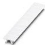
Маркировка для клеммных модулей, Полоса, белый, с маркировкой, маркируется с помощью: CMS-P1-PLOTTER, горизонтально: L1, L2, L3, N, PE, L1, L2, L3, N, PE, тип монтажа: крепление в высоких пазах для табличек, для клемм шириной: 6,2 мм, размер маркировочного поля: 6,15 x 10,5 мм, Количество отдельных табличек: 10
