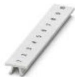
Планка Zack, Полоса, белый, с маркировкой, маркируется с помощью: CMS-P1-PLOTTER, надписи вдоль: нумерация по порядку 1 ...10, 11 ...20 и т.д. до 491 ...500, тип монтажа: крепление в высоких пазах для табличек, для клемм шириной: 6,2 мм, размер маркировочного поля: 6,15 x 10,5 мм, Количество отдельных табличек: 10
