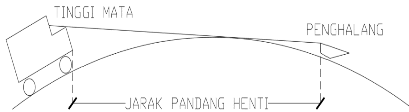
Gambar 3. Jarak pandang henti lengkung cembung
