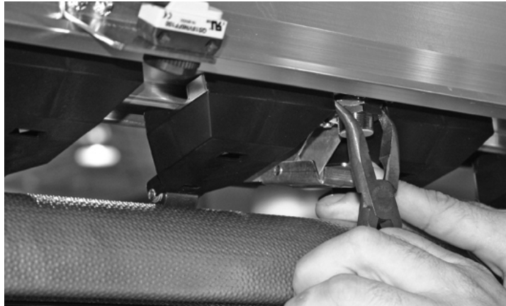
Fig. 4-8. Sensore di spessore del supporto (per chiarezza, sono state rimosse le spazzole non necessarie per eseguire la procedura)
