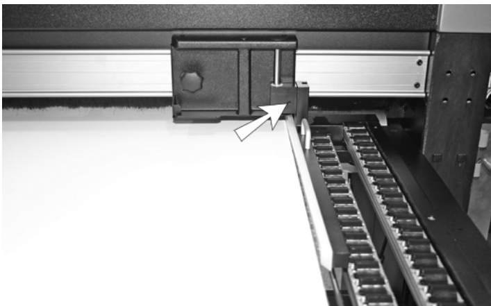
Fig. 2-12. Ubicazione della vite di posizione
