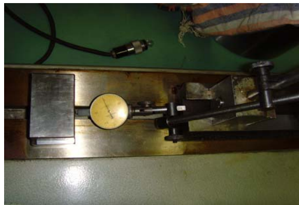
Slika 17. Metod merenja i provera ispravnosti komparatora
