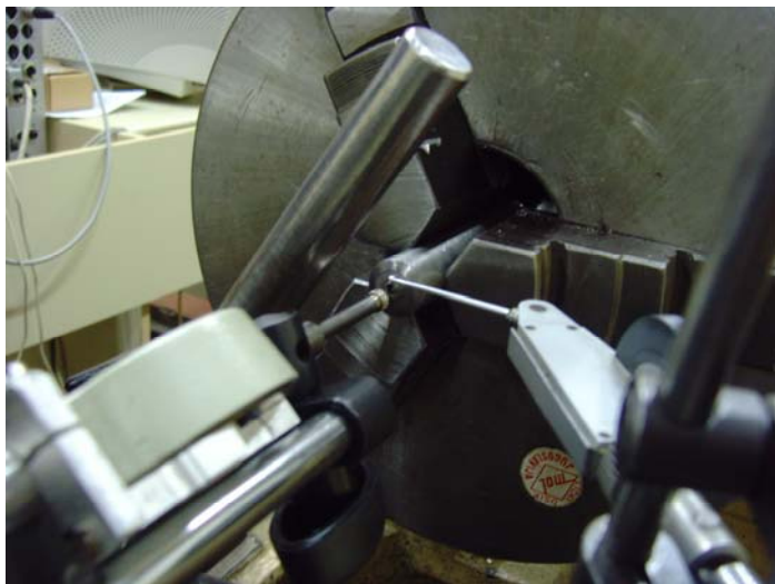
Slika 19. Saosnost električnog komparatora sa osom glavnog vretena
