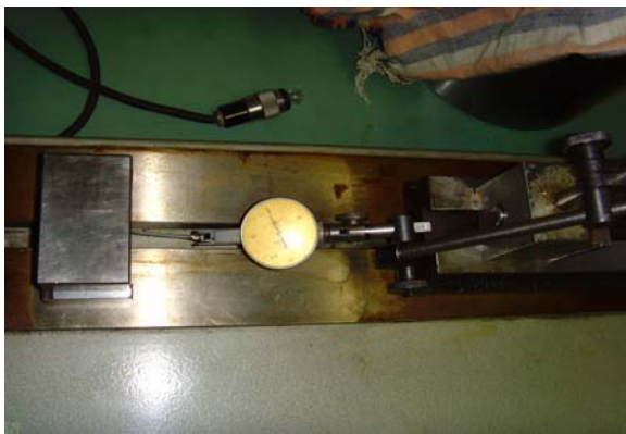
Slika 17. Metod merenja i provera ispravnosti komparatora
