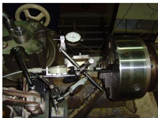
Slika 15. Raspored mernih mesta za neposredno merenje pomeraja
