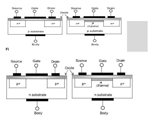
Figure 1.5: (c) Enhancement P-type MOSFET (d) Depletion P-type MOSFET
