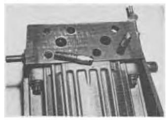
FIG. 21. Aligning Pins
