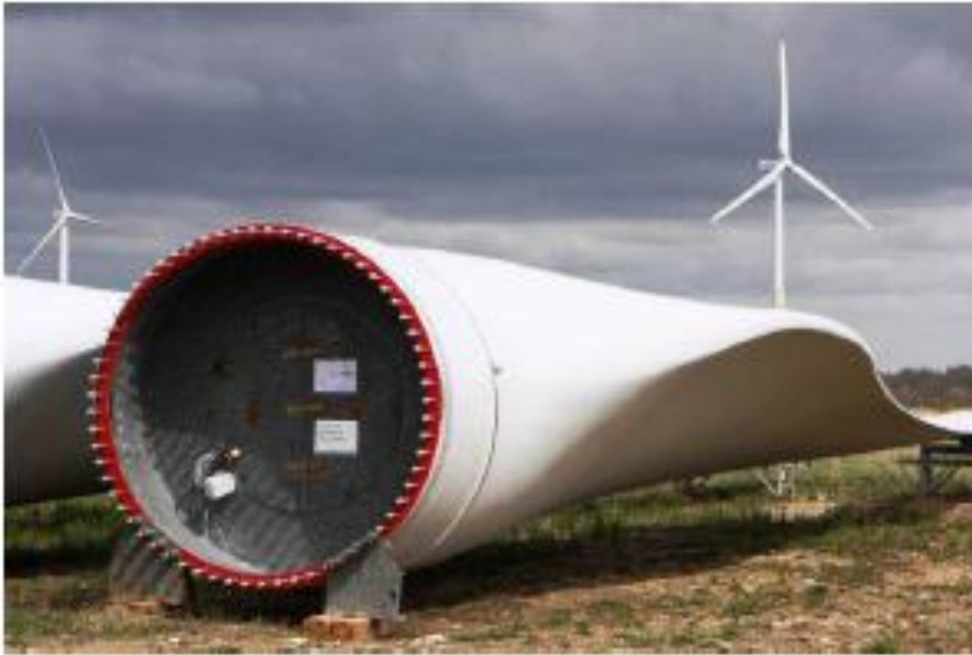
Tuulivoimalan roottorin lapa odottamassa asennusta (kuva: WinWinD)
