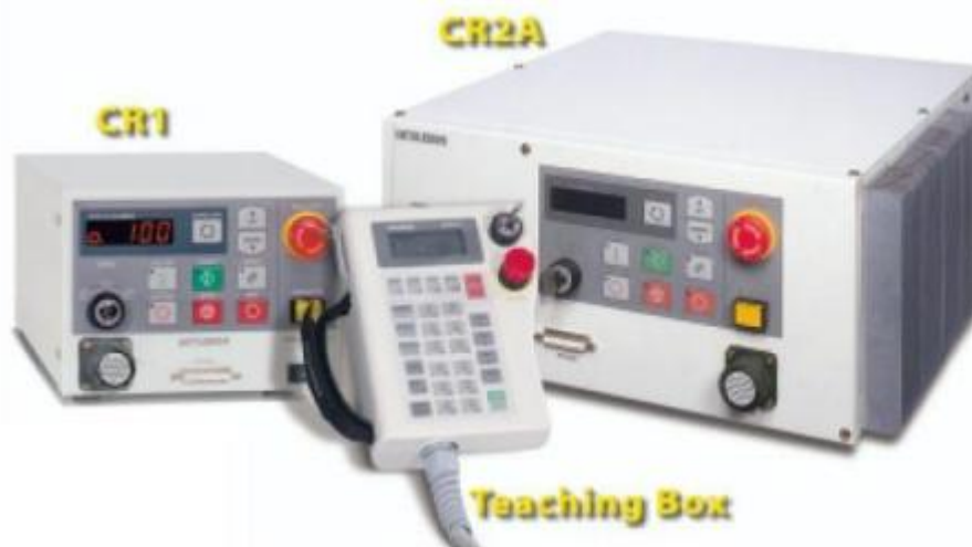
21. ábra A Mitsubishi robotok vezérlői és egy kézi vezérlő
