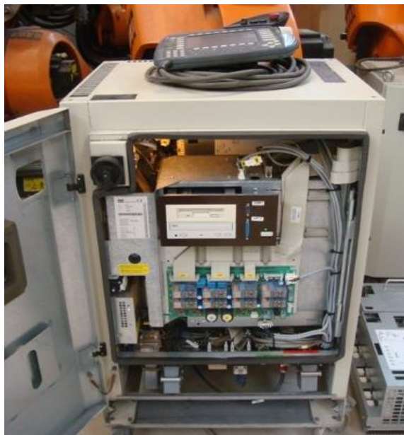
16. ábra KUKA KRC1 vezérlő belseje, illetve a kézi vezérlőpanel [ http://www.robotpartner.de ]
