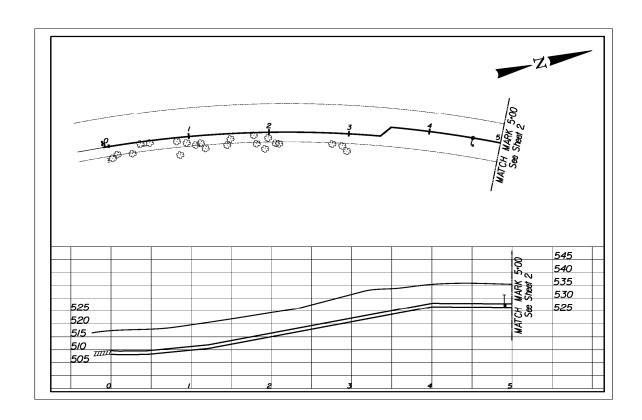
FIGURE 2.16.1: TYPICAL MATCH MARKS FOR A SINGLE UTILITY PROJECT
