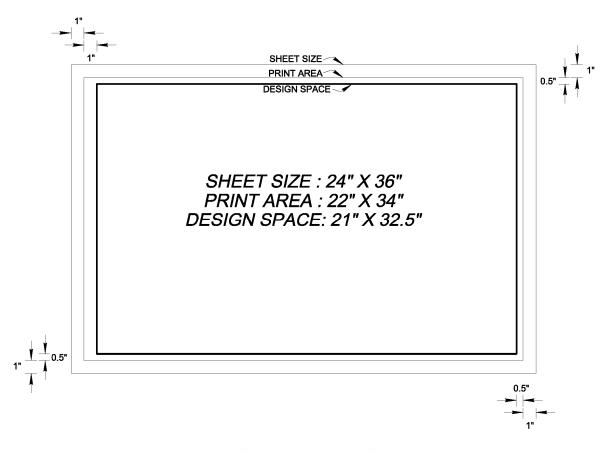
FIGURE 3.5.1 STANDARD DESIGN SHEET BORDER
