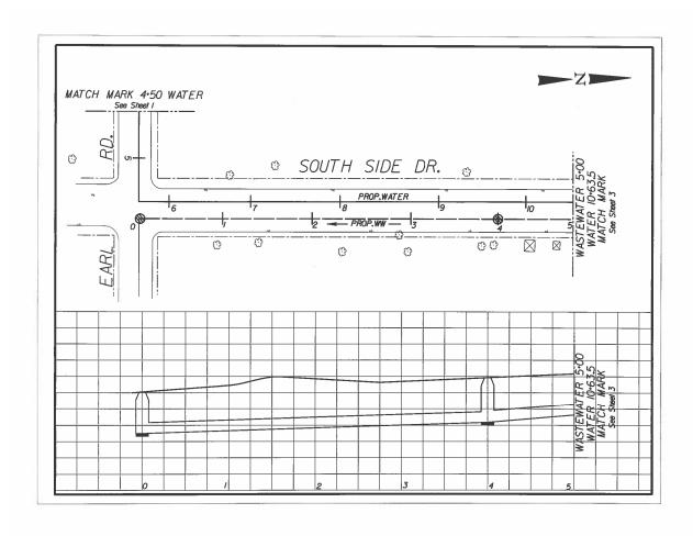
FIGURE 2.16.2: TYPICAL MATCH MARKS FOR A COMBINED UTILITY PROJECT
