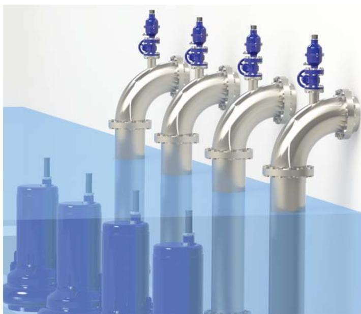
La ilustración de la izquierda muestra la instalación de ventosas de aguas residuales anti-ariete instaladas en la parte alta de la tubería de impulsión justo aguas-arriba de la válvula de retención.
