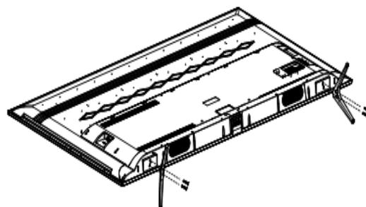
Для того чтобы установить телевизор, закрепите на корпус телевизора основание опоры (опорные ножки) винтами, которые прилагаются в комплекте.
