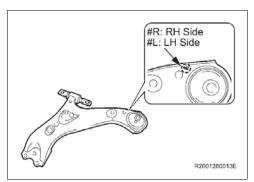
1. CHECK THE MARK STAMPED ON THE *NEW* FRONT LOWER NO. 1 ARM SUB-ASSEMBLY
