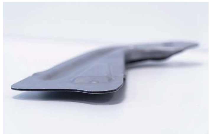
Ein umgeformter Längslenker aus einem hybriden Mehrschichtverbund. Seine besondere Beschaffenheit als Leichtbaustruktur wird am Rand sichtbar. Bild: LiA, Universität Paderborn
