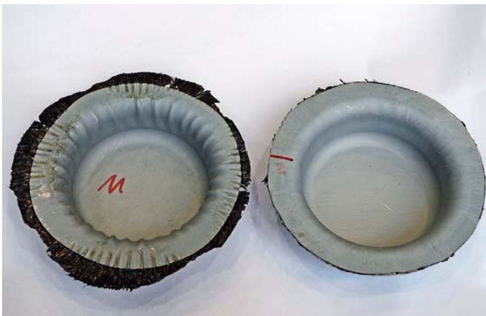
Links: umgeformter Hybridverbund ohne gesonderte Maßnahmen, Rechts: Umformergebnis eines Mehrschichtverbunds, bei dem vor dem Besäumen in HyOpt entwickelte Maßnahmen umgesetzt wurden. Bild: LUF, Universität Paderborn
