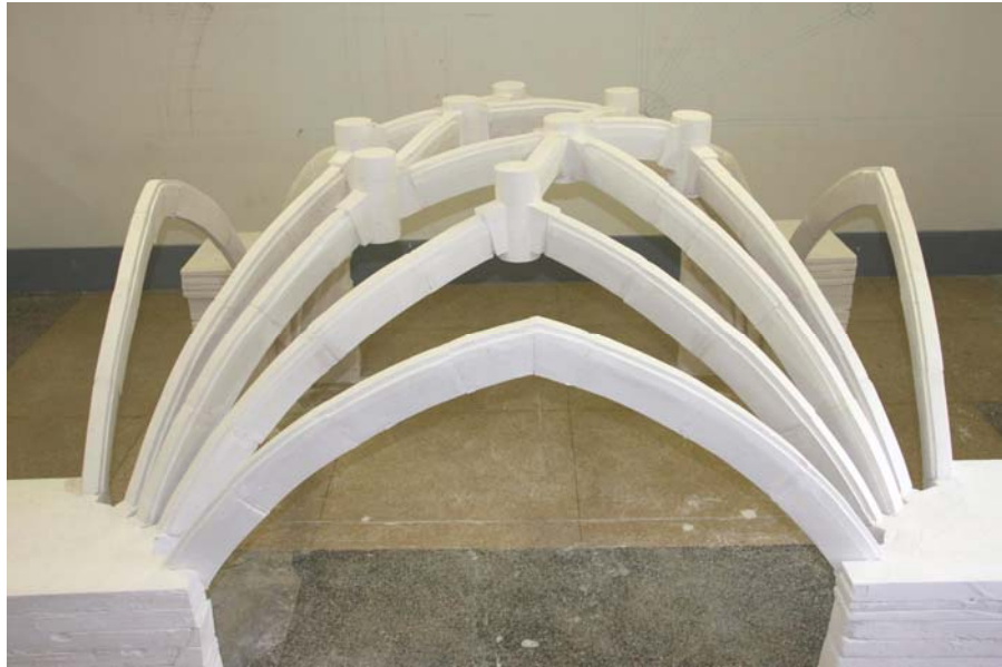
Fig. 8 Juan Guas' vault model built at the Escuela de Arquitectura de Madrid.
