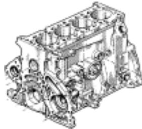
C'est "le châssis" du moteur: il comporte les cylindres.
