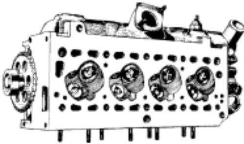
Elle sert de couvercle en haut des cylindres. Souvent, elle comporte les chambres de combustion, les bougies, les injecteurs, les conduits d'air (admission et échappement).
