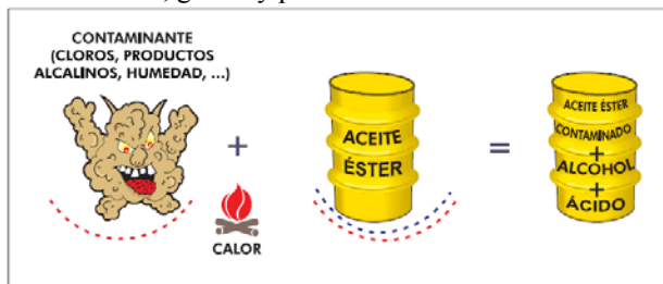
Figura 41 – Reacción química del R 134a entre contaminantes y aceite éster
