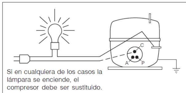
Figura 24.a - Prueba de las bobinas del Compresor EM.
