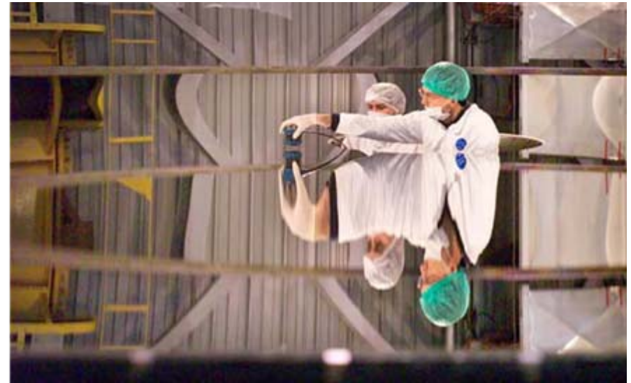
Espejo de Gemini Sur con recubrimiento de Ag
