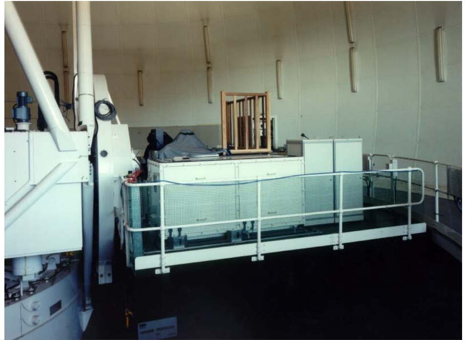
Utrech Echelle Spectrograph (UES) en una de las plataformas Nasmyth del WHT
