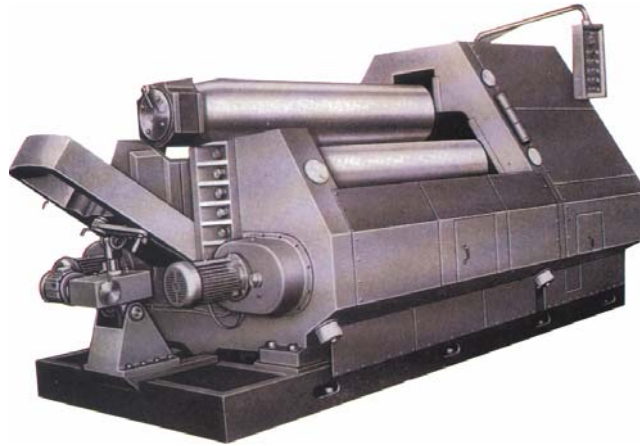
Figura 15. Tren de rodillos de enderezado.
