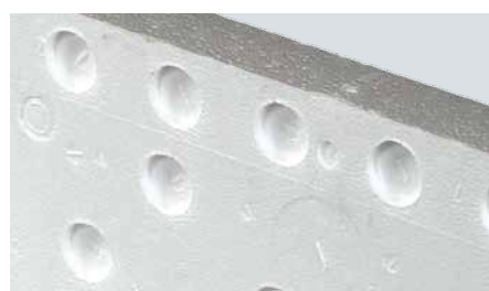
6 Optimale betonhechting door taps toelopende uitsparingen
