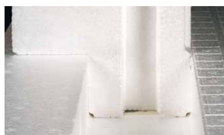
5 Geen weglappend betonwater dankzij messing-groefaansluiting
