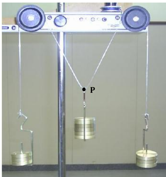
Figura 1 - (a) Sistema em equilíbrio estático. (b) Diagrama de corpo livre para o sistema.
