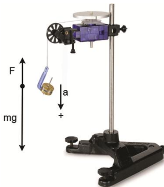
Figura 2 - Montagem do aparato experimental e diagrama de corpo livre para o peso pendurado na polia.
