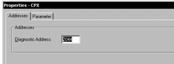
Fig. 2/7 : Modification de l'adresse de diagnostic à l'aide du logiciel Siemens STEP 7 – HW Config
