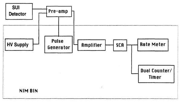
FIGURE 1. BLOCK DIAGRAM OF SUI SYSTEM SETUP
