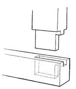
FIG. 1. COMPLETED JOINT SHOWING HAUNCH
