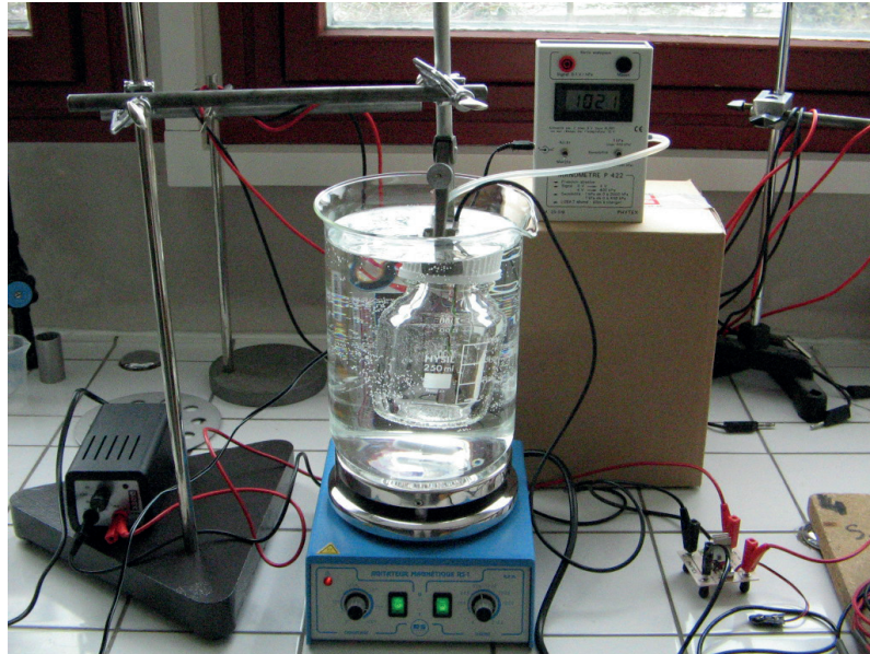
Figure 1.9 Dispositif expérimental pour tester la loi de Gay-Lussac.
