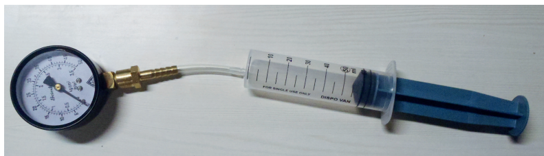
Figure 1.6 Dispositif expérimental pour tester la loi de Boyle-Mariotte.
