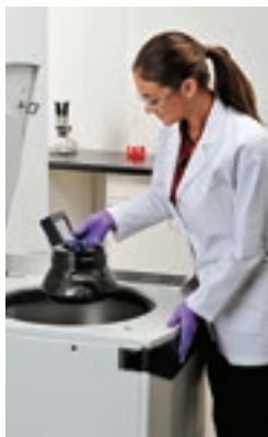
1. 遠心チャンバー内のドライブシャフトにロータを装着
