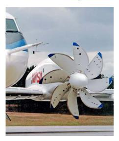
Figure 4-7. The propfan on the Gulfstream II. (NASA)
