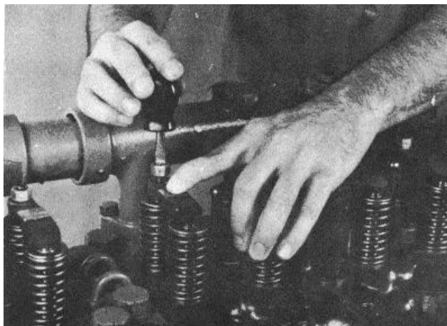
Fig. 14-66 (N114279). Adjust The Crosshead.
