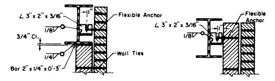
WALL ANCHORAGE TO STEEL BEAM \*
