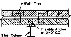
STEEL COLUMN - NO CONTROL JOINT
