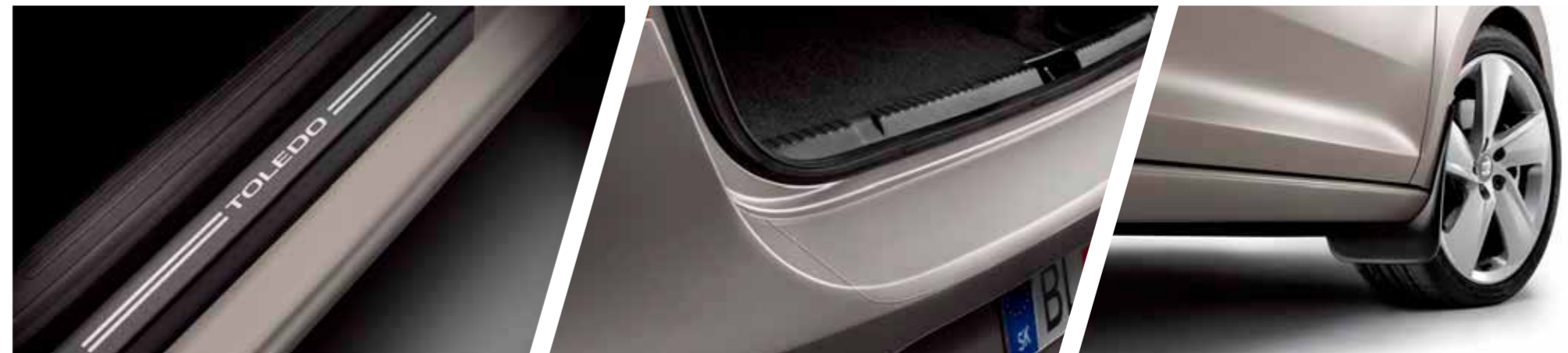
FÓLIE NA BOČNÉ PRAHY. Samolepiace pruhy prispôsobené tvaru prahov dverí, aby ochránili vstupný priestor pre cestujúcich. 6JA071691B
