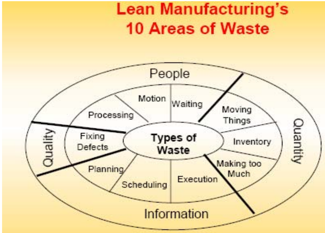
Bagan IV.3 Sepuluh Areas of Waste dalam Industri Manufaktur (Sumber: Kaufman Consulting Group, 1999)
