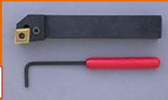
Herramienta de torneado exterior plaquita de widia cambiable.
