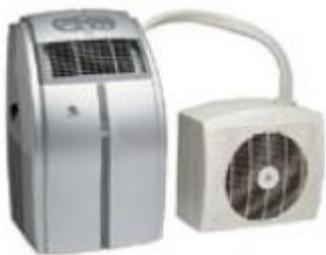
Il est composé de 2 unités reliées par des tuyauteries de petits diamètres (gaines plates). L'une est placée dans la pièce à climatiser, l'autre à l'extérieur. L'unité intérieure, souvent équipée de roulettes, et la « valise » extérieure sont facilement déplaçables (le flexible pouvant être passé par une fenêtre ou une ouverture dans le mur). Il peut climatiser une surface de 10 à 30 m<sup>2</sup>.
