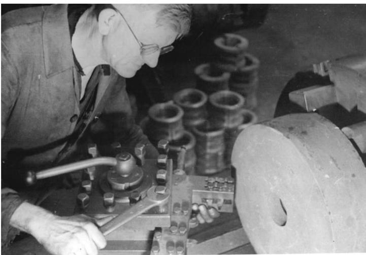
El torneado es un proceso de mecanizado en el que se reduce el diámetro del material por medio de una herramienta provista de un filo especial. El movimiento de corte se produce haciendo girar la pieza a trabajar, y los
