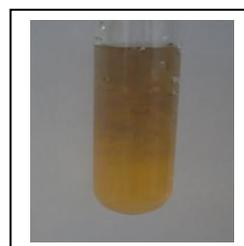
Figura 12. Fotografías que se observa el oscurecimiento de la disolución de vitamina C al caer las gotas de la solución férrica.
