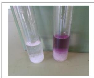
Figura 13. Fotografía en el tubo de ensayo: en la izquierda la disolución hidrolizada de la aspirina y en el tubo de la derecha cuando se le echa la solución férrica.
