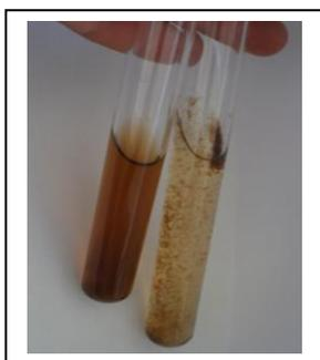
Figura 18. Bebida de cola calentada (izquierda) y la misma bebida de cola con disolución férrica (derecha). Se observa cómo la disolución se decolora y precipita muy lentamente el fosfato de hierro (III).
