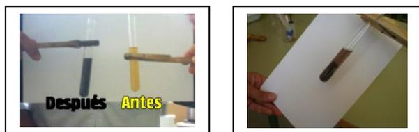
Figura 9. Fotografías que nos muestra el cambio de color al calentar té negro con estropajo de acero.
