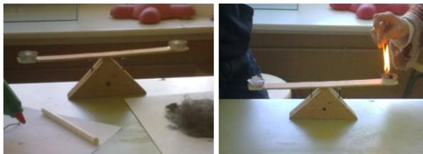
Figura 1. Tras colocar en una balanza un trozo de plastilina y otro de estropajo de acero en equilibrio (izquierda), se quema el acero (derecha) y se desequilibra la balanza por el aumento de peso al formarse óxido de hierro.
