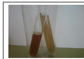
Figura 16. Tubo de ensayo con un poco de café de sobre con agua (derecha) y la misma disolución de café con disolución férrica (izquierda). Se observa una intensificación del color.
