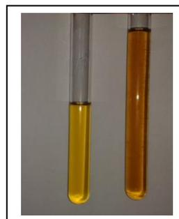
Figura 15. En el tubo de la izquierda de muestra la disolución de comino y, en el de la derecha, la disolución de comino con solución férrica observando un color más intenso.
