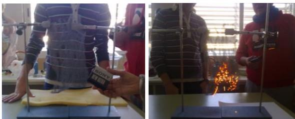
Figura 4. Colocación de la lana de acero (izquierda) para observar el efecto Joule que se genera con una pila y que provoca la combustión del metal (derecha).
