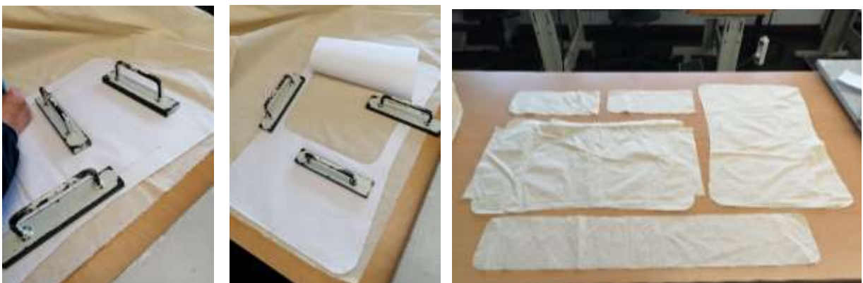
Figura 59 - Planificação do molde em papel no tecido
