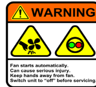
Fan Warning Nameplates
