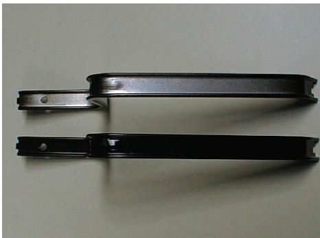
Img. 2.4.1. Poor wrap-around
