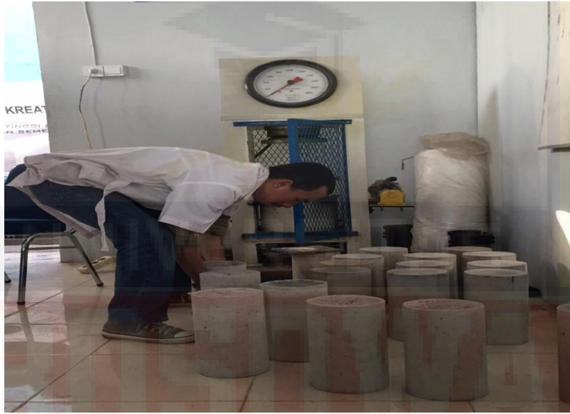
Uji kuat tekan beton normal
