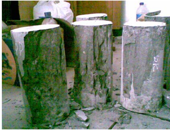
Pecahan benda uji setelah pengujian kuat desak
