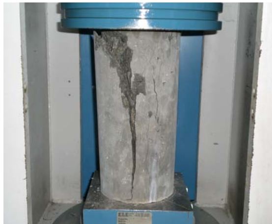
Pengujian kuat desak beton
