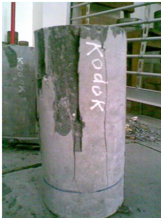
Pecahan benda uji setelah pengujian tegangan dan regangan
