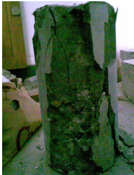
Gambar 5.2 Pecahan benda uji setelah pengujian kuat desak
