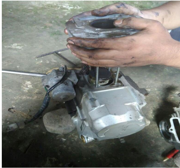
Gambar 3.21. Penukaran Piston Flat menjadi Piston Dome
