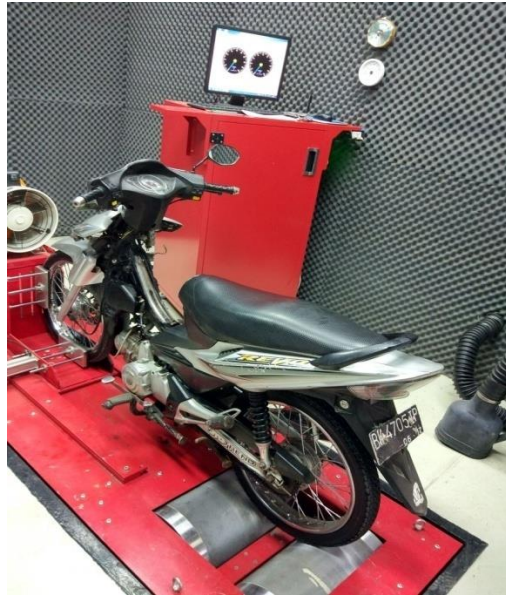
Gambar 3.29. Menaikkan Sepeda Motor Keatas Meja Dynotest
