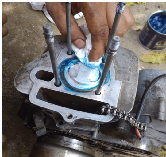
Gambar 3.17. Pemberian Lapisan Grease tipis pada posisi TMA
