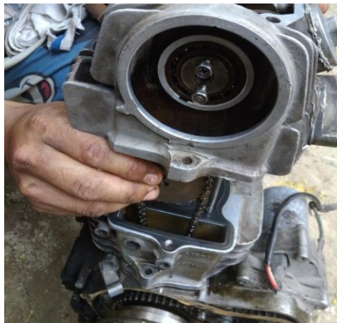
Gambar 3.15. Pemasangan Kepala Silinder
