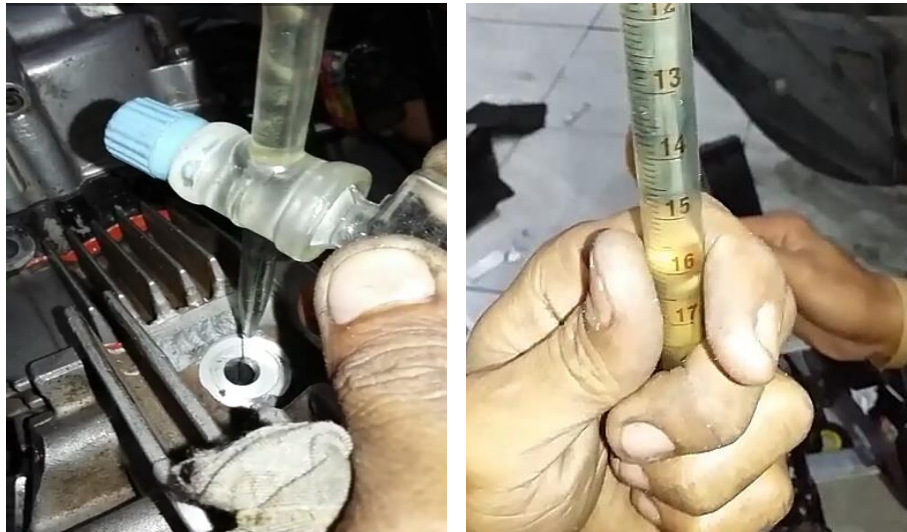
Gambar 3.18. Mengukur Volume Ruang Bakar
