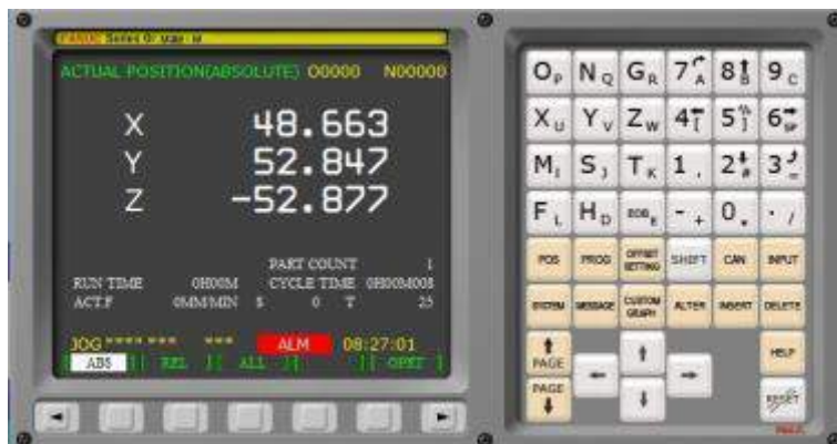
Gambar. Papan Ketik (CNC Keyboard) dan Layar pada Sistem Kontrol CNC Fanuc Oi Mate untuk Mesin Bubut dan Mesin Frais
