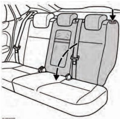
Pritisnite tipku za otpuštanje na naslonu i preklopite naslone prema naprijed.
